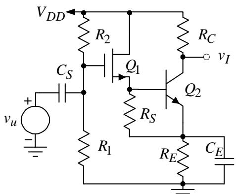
6. Za pojačavač sa slike, parametri tranzistora su  $\beta_F = \beta_0 = 100$ ,  $V_{BE} = 0.7V$ ,  $V_{CES} = 0.2V$ ,  $V_t = 25mV$ ,  $V_A \rightarrow \infty$ , dok su ostali parametri u kolu  $V_{CC} = 12V$ ,  $R_{E1} = R_{E2} = 1k\Omega$ ,  $R_P = 1k\Omega$ .
